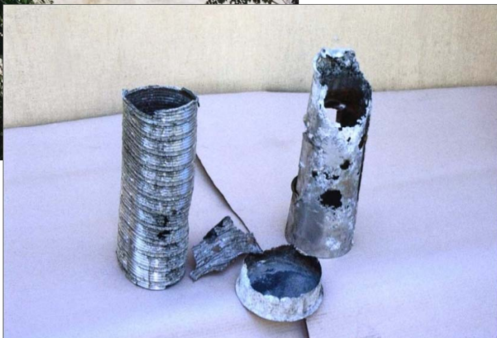
A korrózió által tönkrement alumínium béléscsövek
